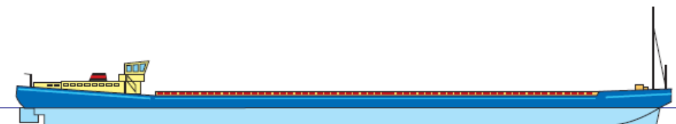
Convoi moderne constitué d'un pousseur et de barges, capacité 2 500 t à 5 000 t, longueur 143 à 185 m
